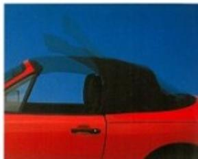
Der elektrisch betätigte Verdeckzubringer erleichtert das Öffnen und Schließen
