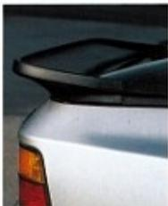
Bessere Aerodynamik und geringere Auftriebskräfte durch den Heckspoiler
