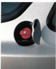
*Der Tankverschluss ist durch eine Klappe abgedeckt*
