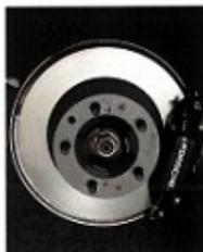
Auch die Hinterradbremmen verfügen über innenbelüftete Bremsscheiben
