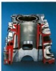
Zylinderblock und Pleuellager aus Leichtmetall mit gleicher Wärmeausdehnung
