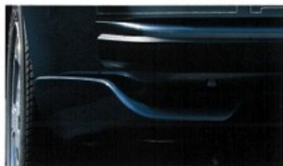
Der Kunststoff-Stoßfänger kann leichte Stöße bei Aufprallgeschwindigkeiten bis 5 km/h schadlos absorbieren
