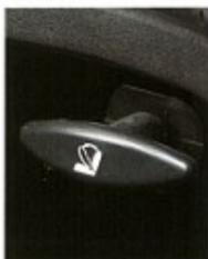
Die Rücksitzlehnen lassen sich einzeln nach Hebelbetätigung umklappen
