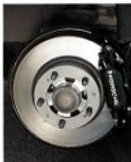
Die Vierkolben-Festsattelbremse mit innenbelüfteten Bremsscheiben vorn
