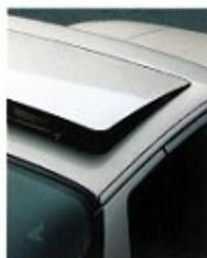
*Das elektrische Dach läßt sich in Hubstellung zur ausgiebigen Lüftung nutzen*
